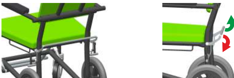
Abb. 4: Funktion des Bremsbügels
