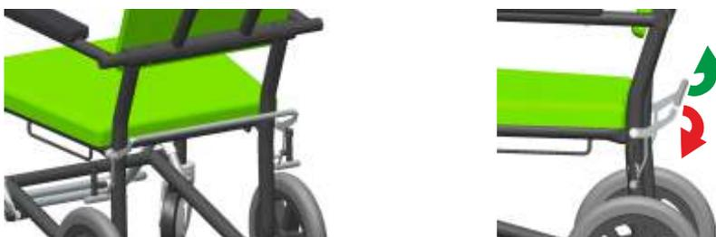
Abb. 4: Funktion des Bremsbügels
